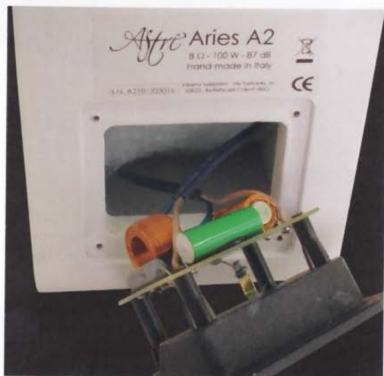
In alto la vaschetta dei contatti delle A2; al centro il crossover curato ma semplice.
