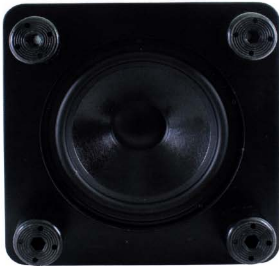
Sotto al woofer, fra i quattro piedoni, ecco la minacciosa presenza del woofer da ben 32 cm di diametro.
