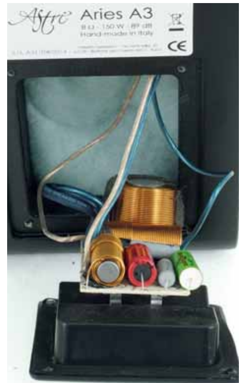
Il crossover a ridosso della morsetteria.
